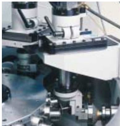
Vertikalsupport für den Aufbau von vertikalen Bearbeitungseinheiten
